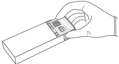
③調製した試料の入った抽出容器から試料4滴(約110 $\mu$ L)をテストカートリッジの試料滴下孔にゆっくり正確に滴下して下さい。
