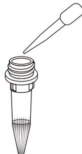
③フィルターを装着して、容器を数回、軽く揺すって充分混和し、試料とします。
