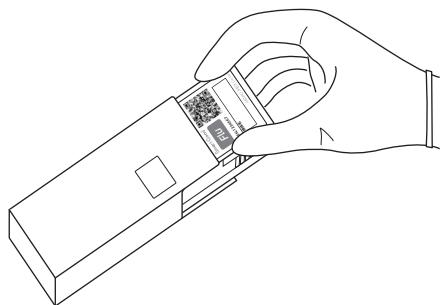
③調製した試料の入った抽出容器から試料4滴(約110μL)をテストカートリッジの試料滴下孔にゆっくり正確に滴下して下さい。
