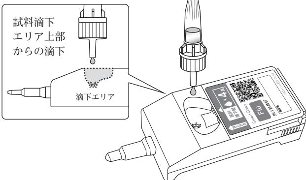
④試料滴下後、試料が吸収されてから、速やかにテストカートリッジを機器のテストカートリッジ挿入口に挿入し、測定を開始して下さい。
